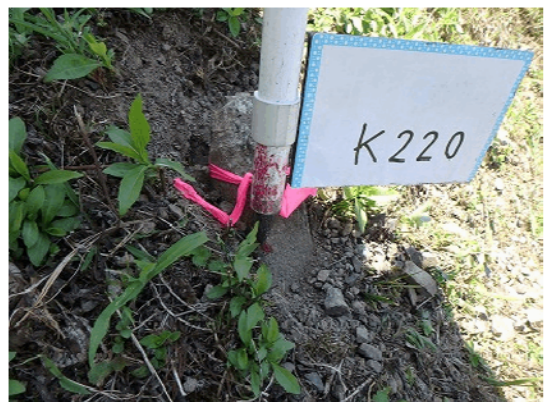
NO. 24 点名 K220 (倒れたコン杭あり)
